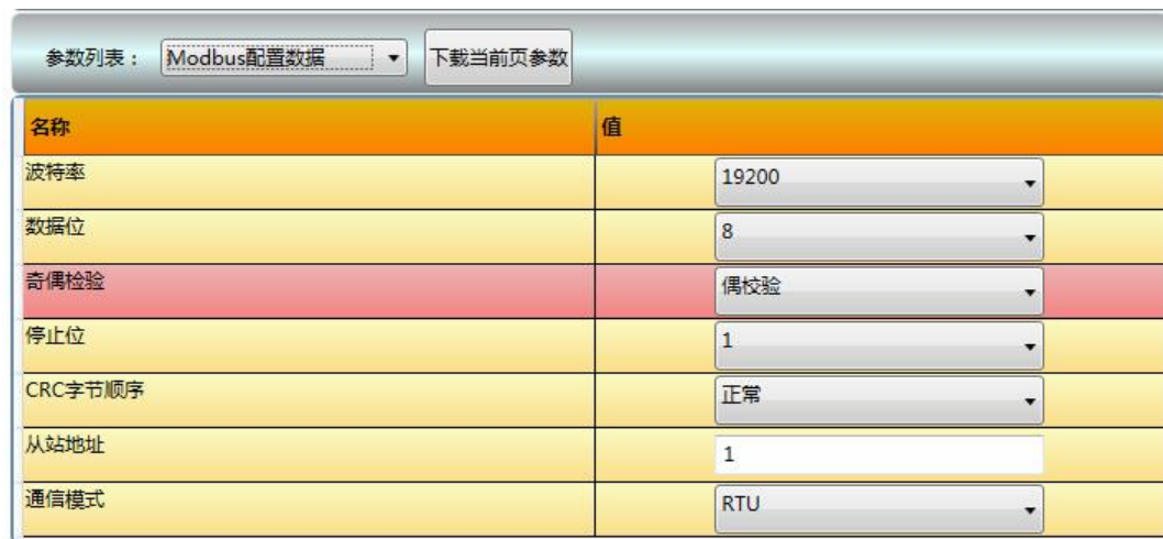
图 7 Modbus 参数配置举例
