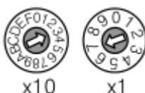
PROFIBUS 总线地址=(x10 旋钮拨码开关的值)\*10+(x1 旋钮拨码开关的值)
