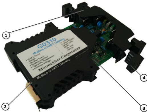
图 1.3 智能变送器整机结构
