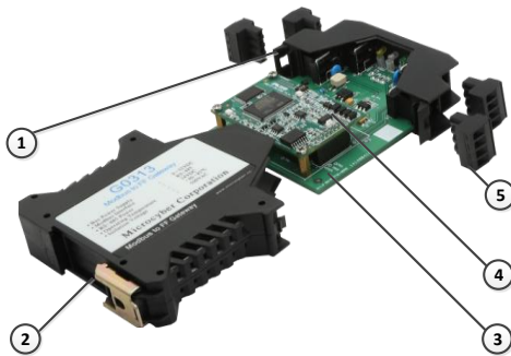
图 1.3 网关设备整机结构
