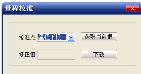
图 5.5 量程校准-校准量程下限
