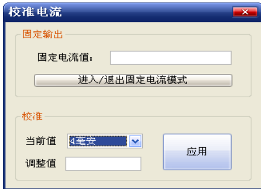
图 5.7 校准电流对话框
